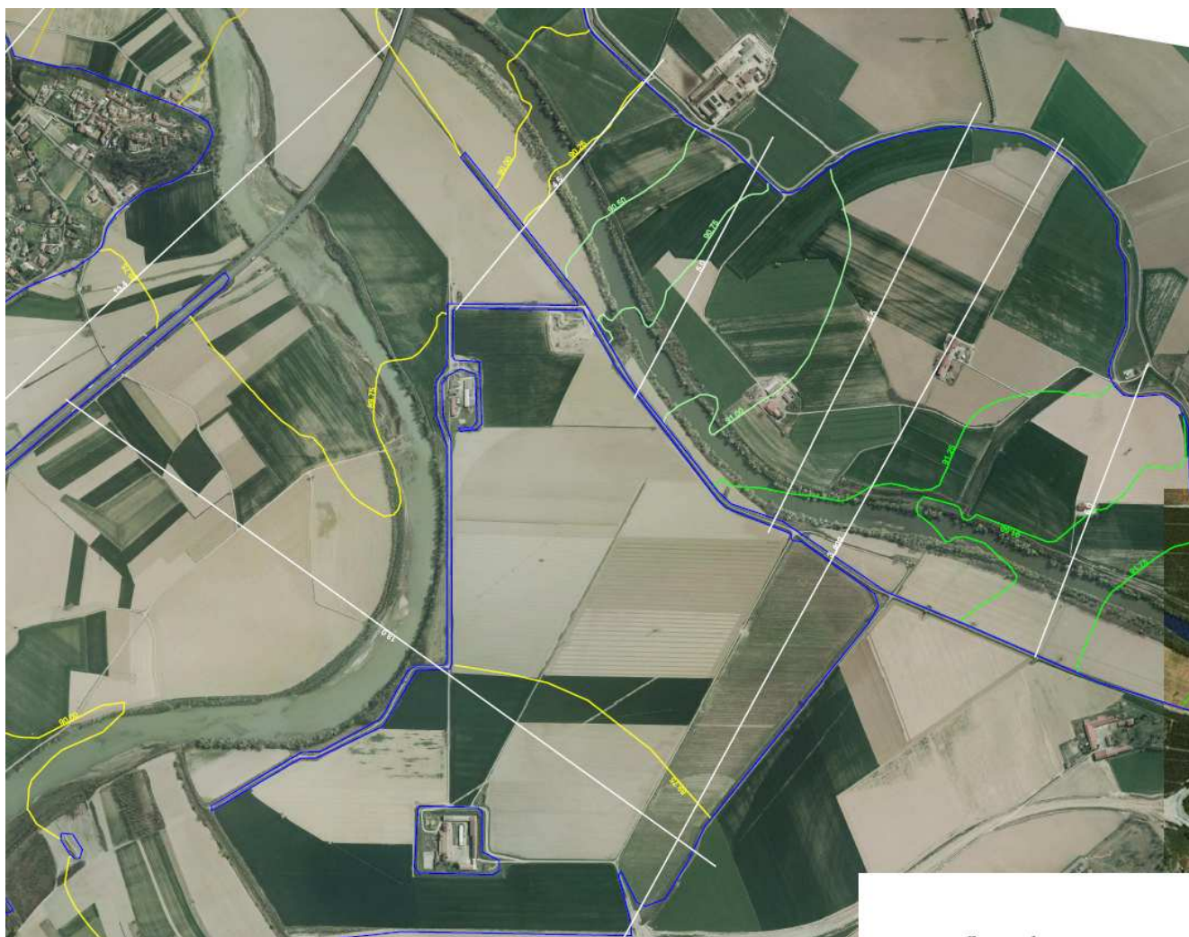
Figura 16: Livelli calcolati sul tratto di monte del Bormida – SDF TR 200 Bormida
