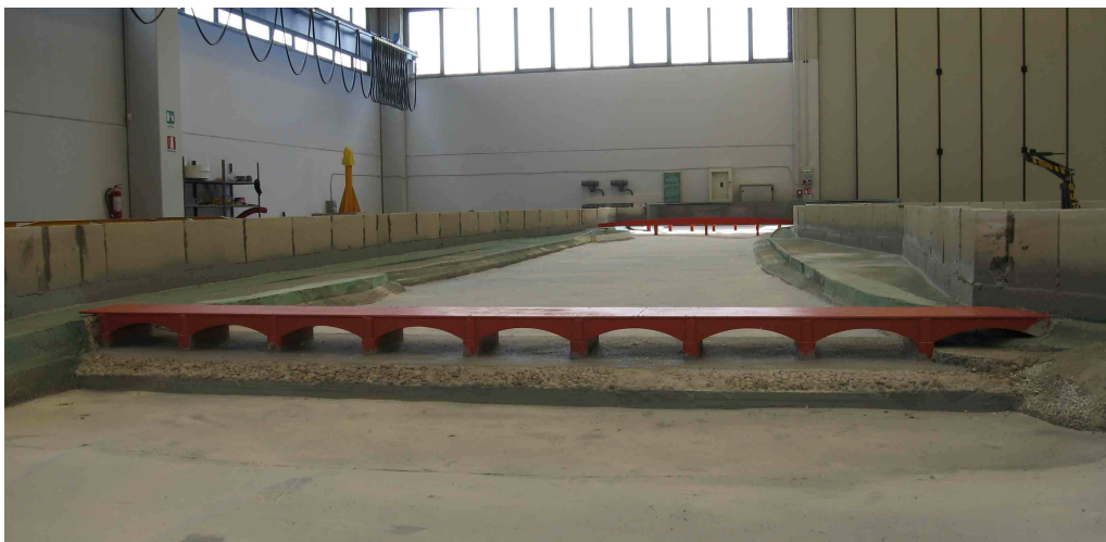
Figura 18 – Porzione del modello fisico nella configurazione a fondo fisso
