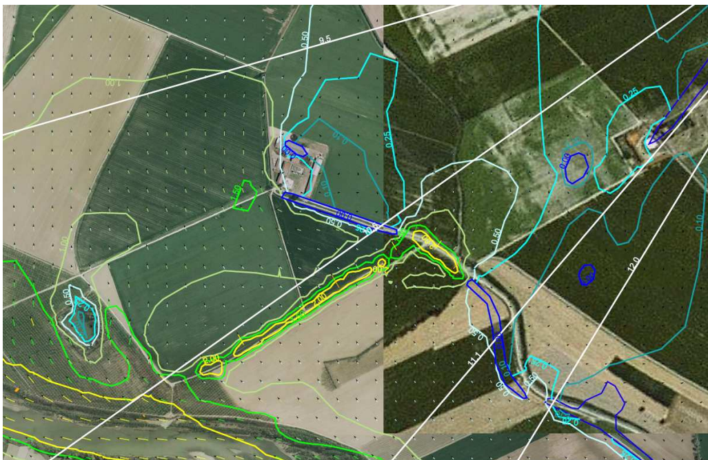
Figura 14: Campo di velocità in corrispondenza della confluenza – SDF TR 200 Tanaro
